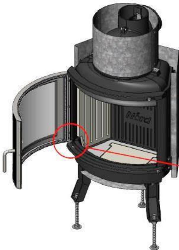
Loch bohren, wenn nicht vorhanden (fi 4.2) und Schraube befestigen (M5)
